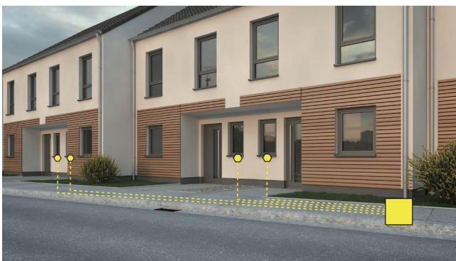
Übergang der Glasfaserinstallation von der Netzwerkebene 3 zum Hausübergabepunkt
